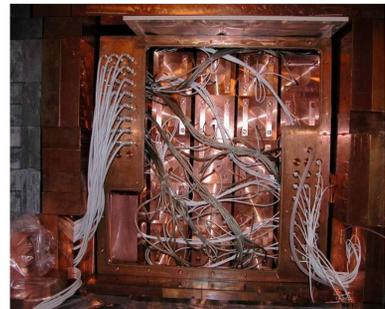
图 14 屏蔽体内晶体探测器阵列
