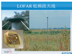
图4 LOFAR的低频段天线与相应的电子附件
