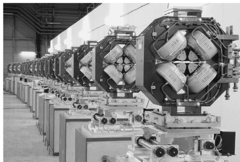
图 7 安装在 ILC-ATF2 传输线上的中科院高能所研制的四极磁铁
