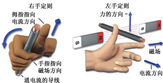
图 3 关于电流产生磁场的右手定则和导线在磁场中受力的左手定则
