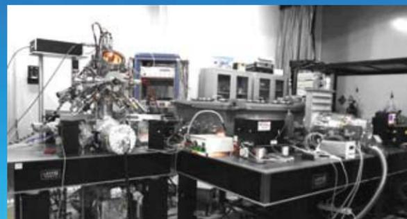
深紫外光耦合扫描隧道显微镜
