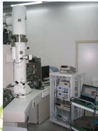
扫描探针-透射电子显微镜
