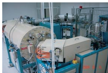
图 3 14 C 专用加速器质谱计装置 [5]
