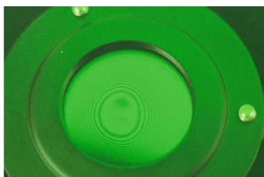
图7 用绿色光拍到的牛顿环的实验图景
