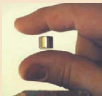
图6 用手指的反磁性来实现浮空磁铁的稳定
