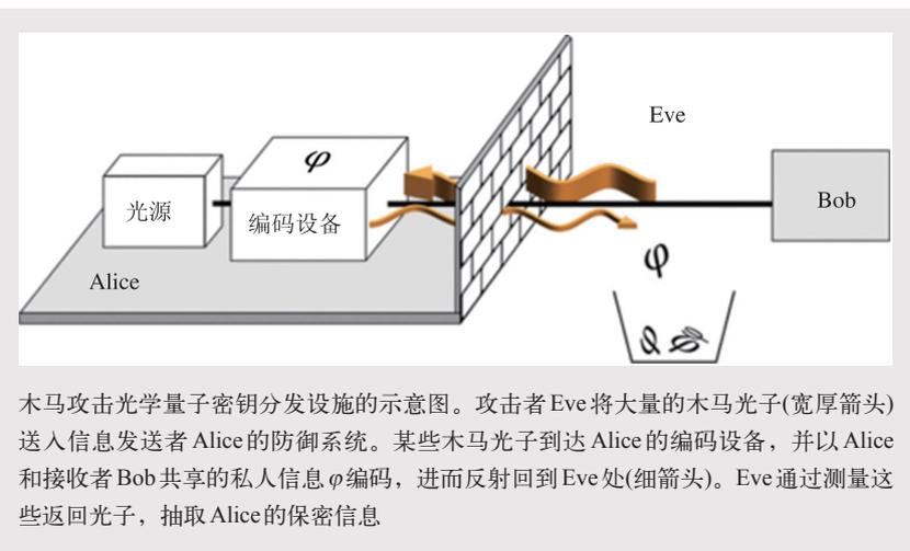
木马攻击光学量子密钥分发设施的示意图。攻击者 Eve 将大量的木马光子(宽厚箭头)送入信息发送者 Alice 的防御系统。某些木马光子到达 Alice 的编码设备，并以 Alice 和接收者 Bob 共享的私人信息  $\varphi$  编码，进而反射回到 Eve 处(细箭头)。Eve 通过测量这些返回光子，抽取 Alice 的保密信息
