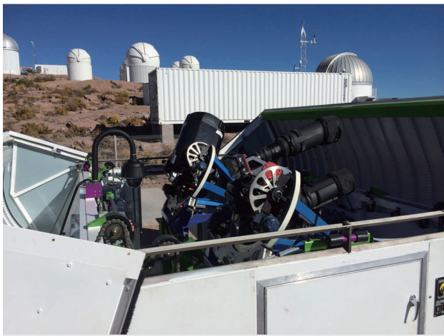
图1 “全天自动超新星搜寻项目”(ASAS-SN)位于智利安第斯山脉托洛洛山顶节点的两架 14 cm 口径的望远镜。天文学家们用它们发现了极亮型超新星 ASASSN-15lh
