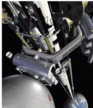
图1 太空电梯靠离心力克服重力得到支撑，可以建立联接地球表面和外层空间的便捷通道。为实现这一概念所需的新型坚固材质，几乎肯定可以借助电脑设计出来
