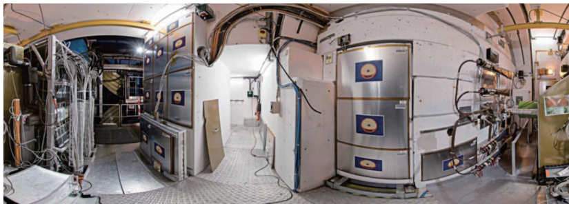
图2 MoEDAL实验装置。该装置用于从质子对撞机产生的碎片中寻找磁单极子。2012年，该设备开展了短期试运行。去年该设置正式投入使用(图片来自CERN)
