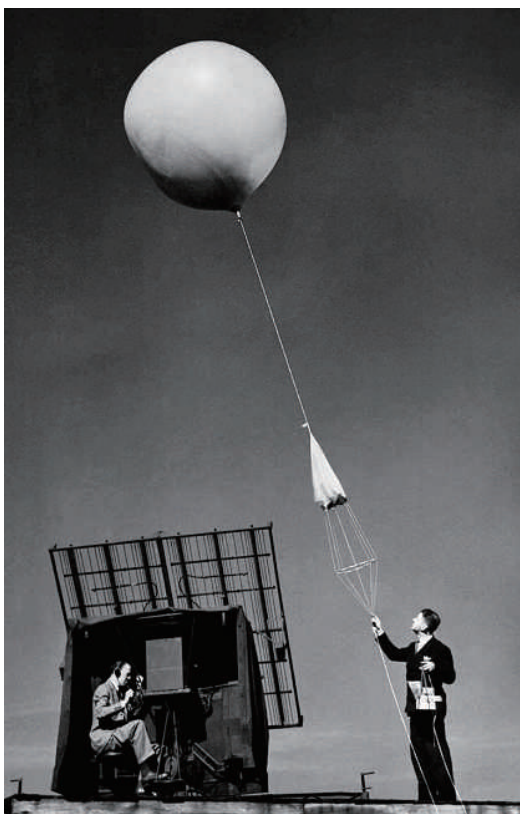
图1 正要放飞的无线探空气球(1940年): 探测仪器系在一个气球上, 测量数据通过无线电传回地面
