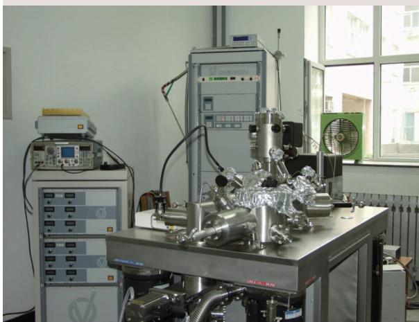
由我国研究人员自行设计的超高真空四探针扫描隧道显微镜(UHV-Nanoprobe-LTSTM)系统。该系统于2002年9月开始装配、调试、投入试运行,可用于原位研究纳米体系的表面结构、电子态结构与电子输运性质
