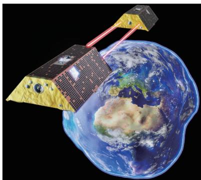
测定地球重力场。GRACE 继任者 (GRACE-FO) 的一对卫星通过激光干涉测量它们之间的距离，从而测绘地球万有引力的微小变化(此图夸张地显示了地球变形导致的引力场改变)
