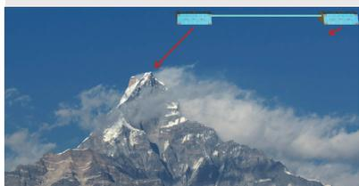
山峰的万有引力。为了解释这一重力测量技术，考虑 GRACE-FO 的一对航天器飞越一座山峰的情形。当飞行器陆续越过山峰时，将被额外的重力向下拽拉，导致卫星间距有序地增加和减少
