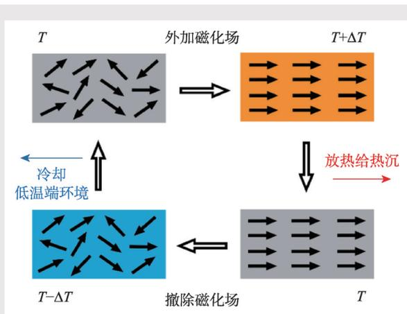
在磁热循环开始时(见图上部),外加磁场迫使材料中的磁分子取向一致,从而降低其磁熵。绝热磁化总体是等熵过程,作为对磁熵降低的补偿,晶格振动相关的熵增加,于是材料的温度升高,高出热沉 $\Delta T$ ,磁化热放出给高温热沉。随后,借助于热交换流体的帮助,工作物质连同外加磁场降低温度,温度降到与低温热沉一致。经历绝热去磁,撤除施加在工质材料的磁场,使磁分子的排列再度混乱。绝热去磁也是等熵过程,低温端的熵增需要晶格熵降低来补偿,工质降温 $\Delta T$ 。最后工质从低温端环境吸热,使得空调或电冰箱可以源源不断地将热量从低温端输送到高温端
