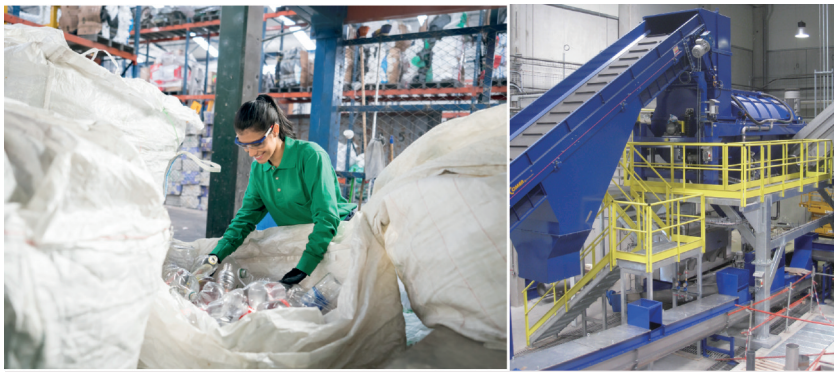
人和机器分选。许多塑料回收厂在某个阶段靠人来分选材料(左图)，如果用自动分拣(右图)，就需要多种方法来分离不同类型的塑料
