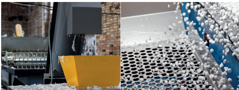
粉碎、融化和成形。大多数塑料回收从粉碎材料开始(左图),然后把它们熔化成颗粒(右图),用于制作新产品
