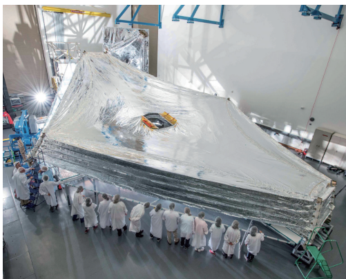
图2 分层遮阳板。这是一个巨型遮阳板的测试模型，可以让詹姆斯·韦布太空望远镜的温度保持足够低
