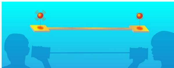
离子通过两端有垫片的金属丝在长距离上耦合。当研究人员用激光冷却一个离子时，他们观察到了另一个离子上的冷却效应
