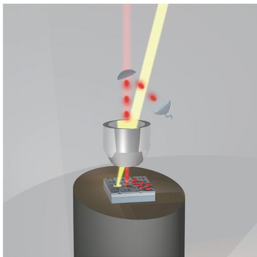
温度有多高？激光束(黄色)加热图案化的硅膜，而另一束激光(红色)则激发膜表面一块晶体中包裹的单个二苯并三萘(DBT)分子。发射光子(红色椭圆)的谱线线形揭示了DBT分子所在位置的温度，表面温度在3—30 K之间
